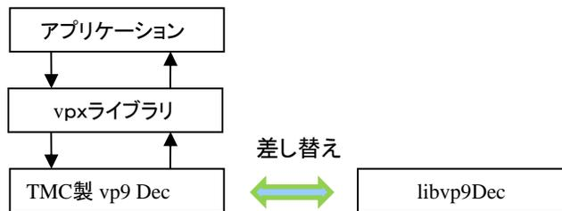
アプリケーションは、vpxライブラリ (VP8、VP9などのVPコーデックをデコードするための共通のAPI) の呼び出しによりデコード処理を実行します。
